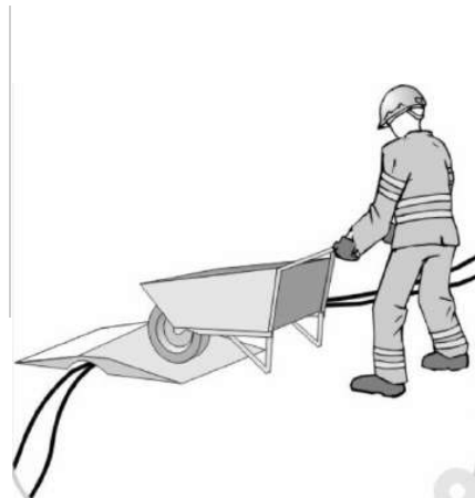
protección de conductores
